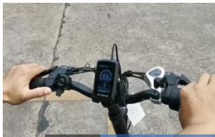
Krok 3: Zapnite displej, a držte po dobu 10sek.
