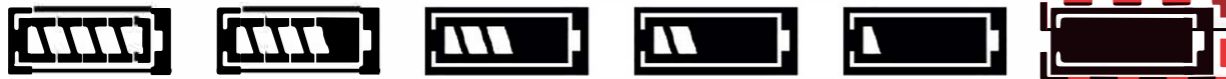
Indikácia úplnej úrovne nabitia batérie 4-segmentová indikácia 3-segmentová indikácia 2-segmentová indikácia 1-segmentová indikácia Blikanie pod napätím
